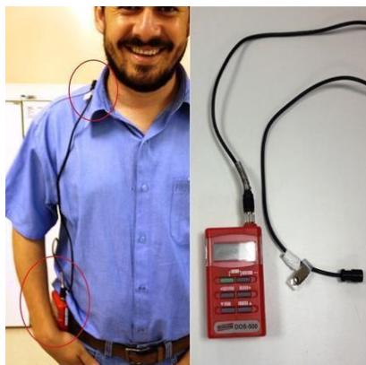
Figura 2 – Dosímetro modelo DOS 50. Fonte: Os autores.
