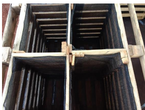
Figura 2. Composteira dividida em quatro partes para permitir a repetição de cada tratamento.
